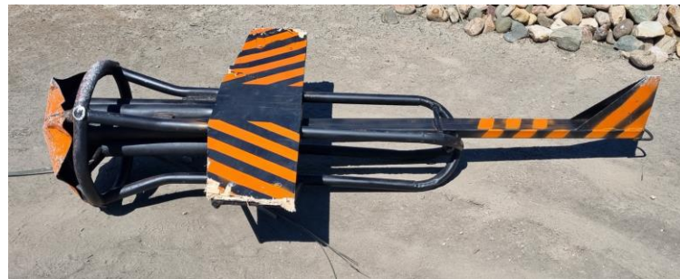
Фото 2. Макет дрона после удара о ДРОНГАРД
